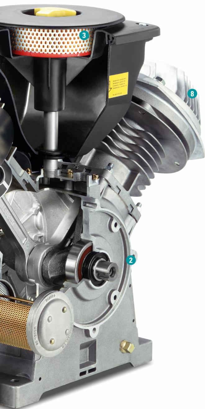
① **Zylinder** wie im Automobilbau aus einer Aluminiumlegierung mit hohem Siliziumanteil und exakter Endbearbeitung für äußerst geringes Spiel und minimierte Reibung.
